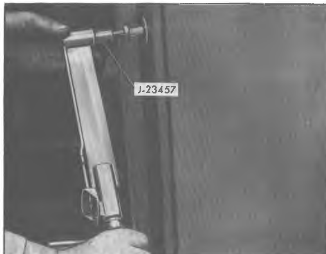
Fig. 13G—Loosening Striker Bolt
