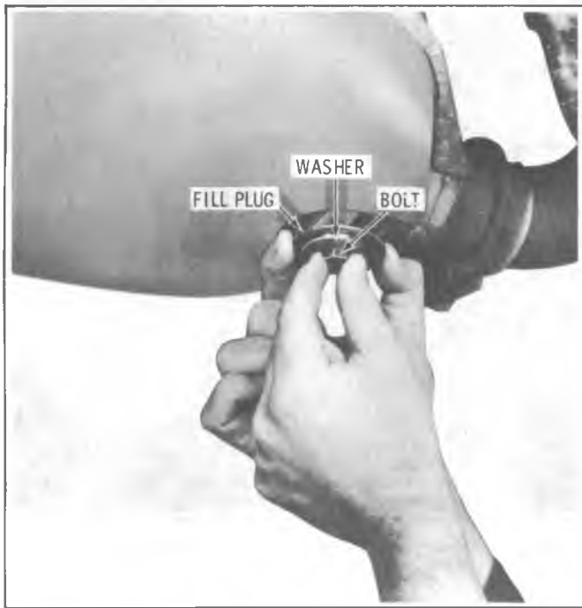
Fig. 6F-12--Installing Fill Plug
