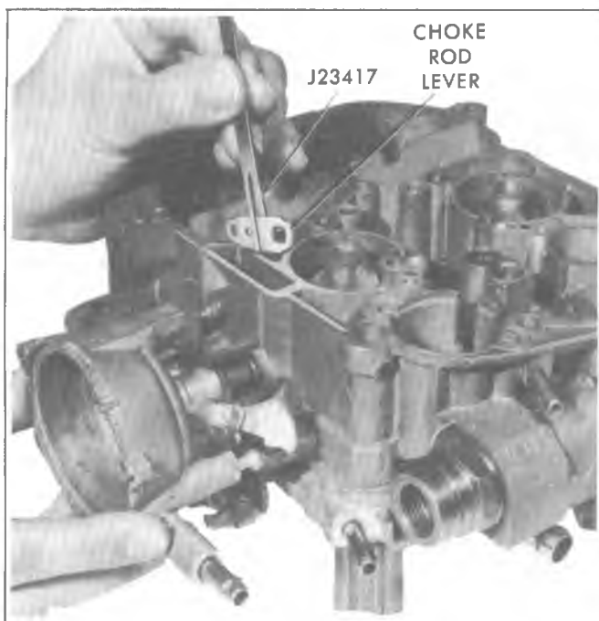
Fig. 6C4-39--Installing Choke Rod Lever
