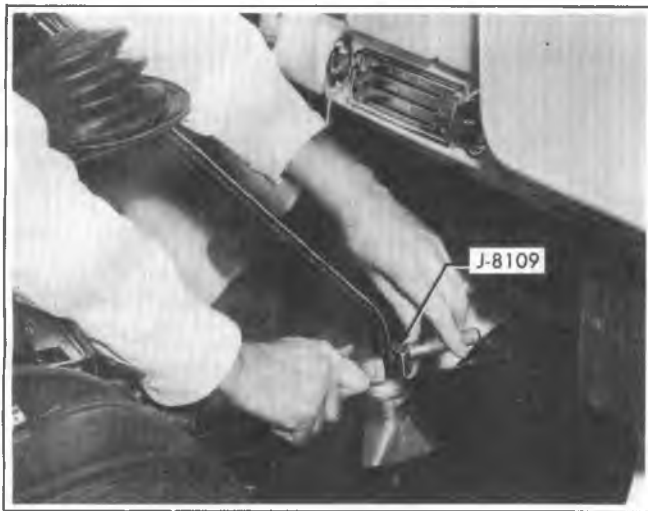
Fig. 7B-14—Removing Gearshift Lever
