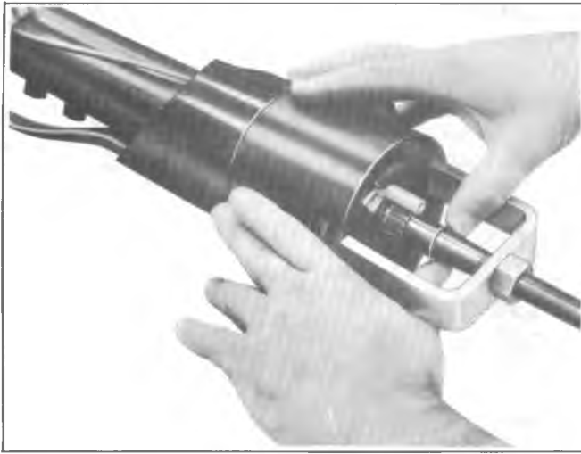
Fig. 3B4-30—Installing Snap Ring
