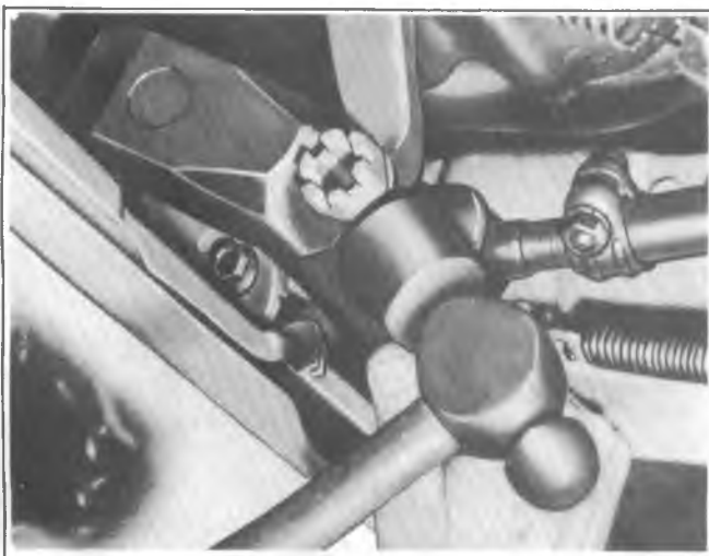
Fig. 3B1-7--Ball Stud Removal-Typical
