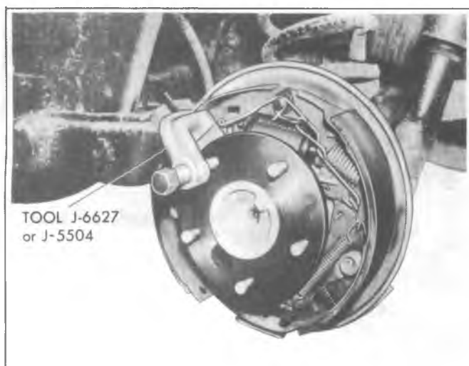
Fig. 4B-23--Pressing Out Wheel Stud
