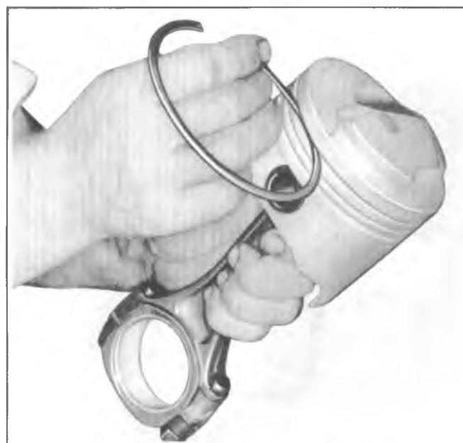
Fig. 6A5-55--Checking Ring in Groove
