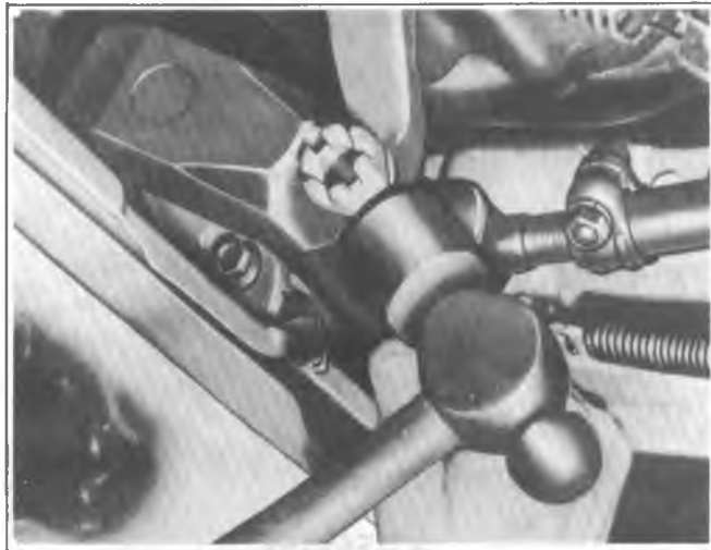
Fig. 3B1-7--Ball Stud Removal-Typical
