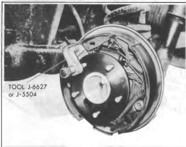
Fig. 4B-23--Pressing Out Wheel Stud
