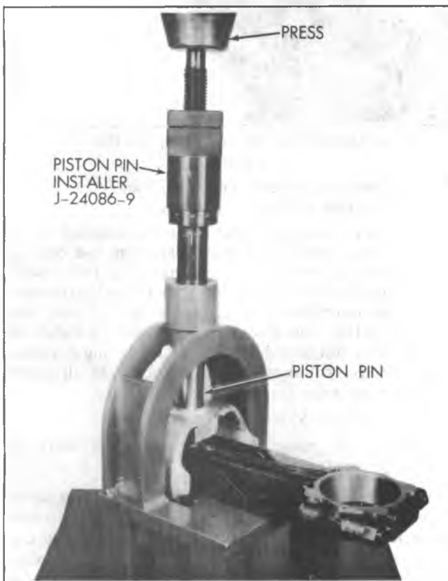
Fig. 6A4-53--Installing Piston Pin
