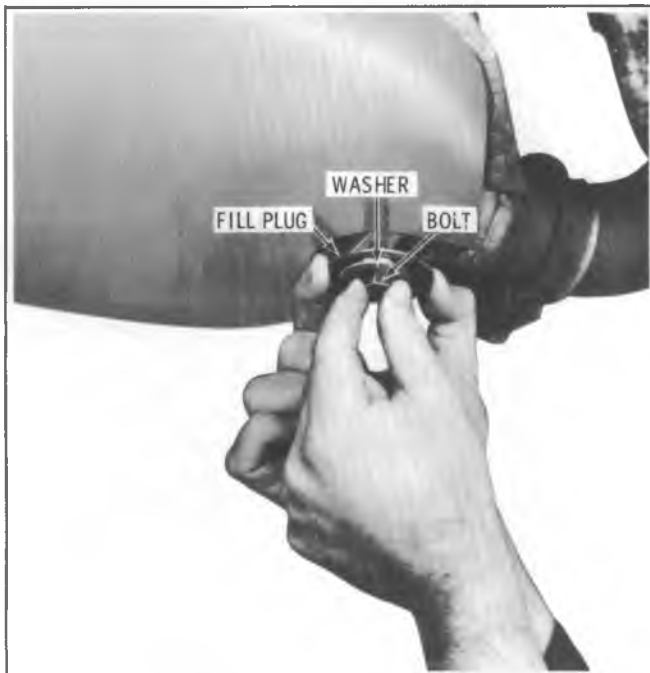
Fig. 6F-10 — Installing Fill Plug
