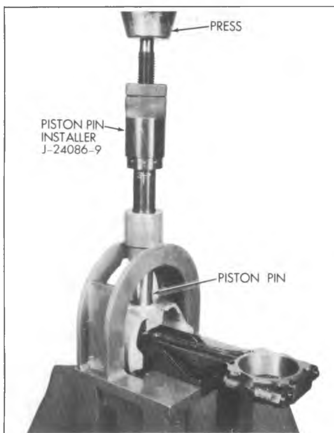
Fig. 6A4-53--Installing Piston Pin
