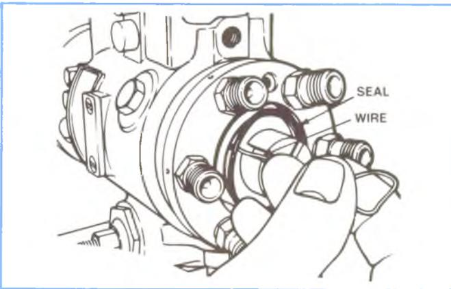
**Figure 4-103, Removing Seal.**
