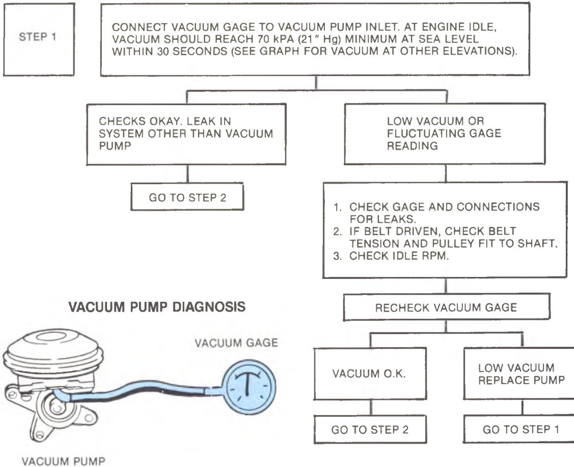
**VACUUM PUMP, NO-LEAK VACUUM
