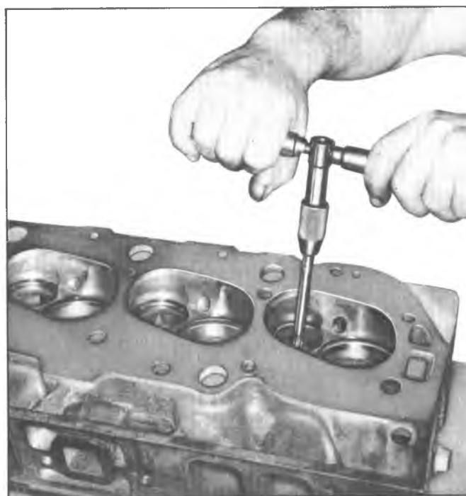
Fig. 22—Reaming Valve Guide
