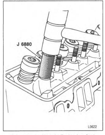
Figure 24-Installing the Rocker Arm Stud
