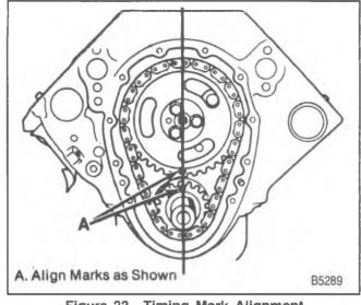
Figure 33—Timing Mark Alignment
