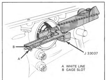
PIN IS PRESET AT FACTORY AND MUST NOT BE READJUSTED
