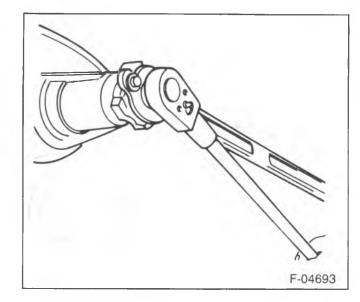
Figure 34—Tightening the Pinion Nut
