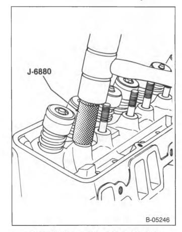
Figure 38—Installing the Rocker Arm Stud
