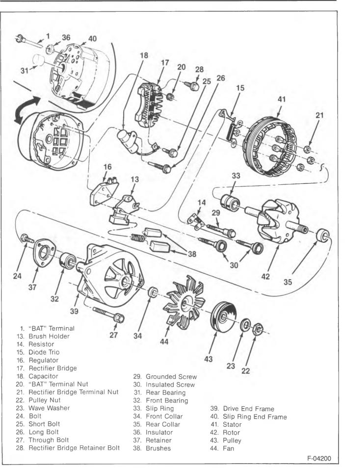
Figure 9—17-SI Series 100 Components
