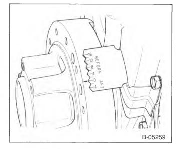
Figure 59—Timing Marks (Typical)
