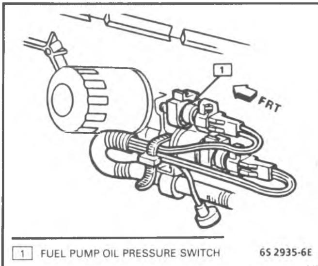
1 FUEL PUMP OIL PRESSURE SWITCH 6S 2935-6E
