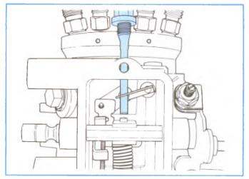
Figure 4-92, Loosening Guide Stud.
