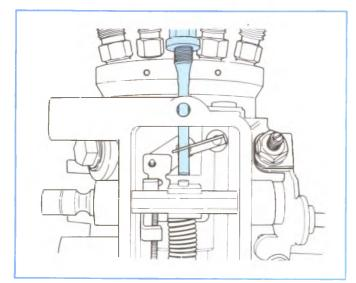
Figure 4-141, Installing Guide Stud.
