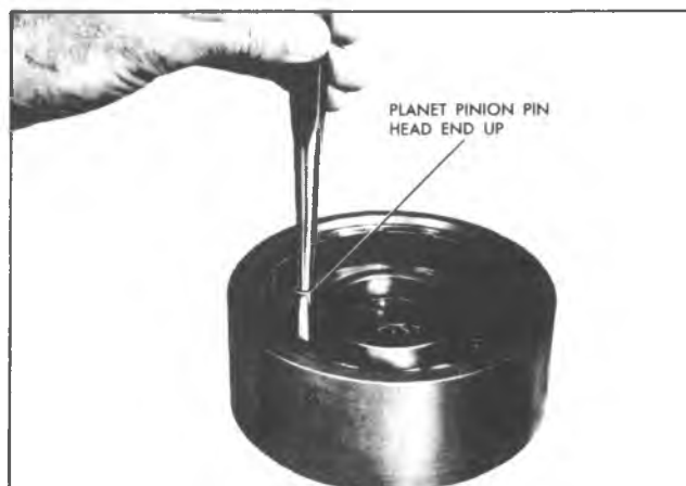
Fig. 7A-132C--Installing Planet Pinion Pin
