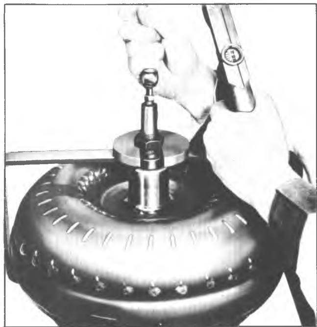
Fig. 7A-138C--Air Checking Converter
