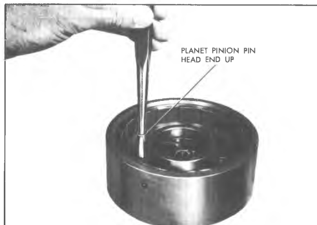
Fig. 7A-132C--Installing Planet Pinion Pin
